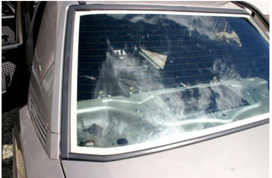
In den Fensterrahmen wird eine dünne Schicht Scheibendichtmasse gespritzt. Mit mindestens 2 Personen wird danach die Scheibe vorsichtig von außen angelegt und von innen mit der Schnur in den Fensterrahmen gezogen.
