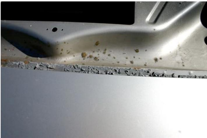
Die Dichtmasse ist ebenfalls aus dem Fensterrahmen komplett zu entfernen. Dazu kann Silikonentferner verwendet werden.
