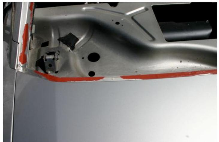
Nicht ganz unvorbereitet habe ich mich dann den Roststellen an den Blechfalzen gewidmet. Mit einer Flexscheibe auf einem Proxxon Feinbohrschleifer wurde der Rost komplett entfernt mit Rost Grundierer und Lack versiegelt.
