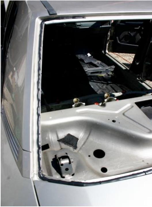
Auf die Scheibe wird die neue Dichtung eingelegt und mit einer Schnur zum Einbau vorbereitet. Nach Montage der Zierleisten ist die Scheibe dann fertig für den Einbau.
