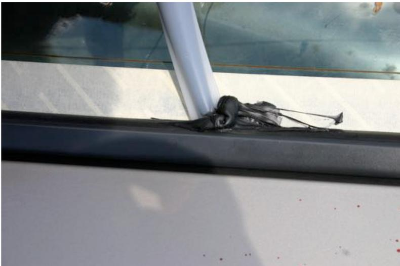
Abschließend wird noch die Dichtmasse zwischen Scheibe und Dichtung gedrückt. Reste der Dichtmasse können mit Silikonentferner entfernt werden. Danach Scheibe gut reinigen und wieder alles einbauen.
